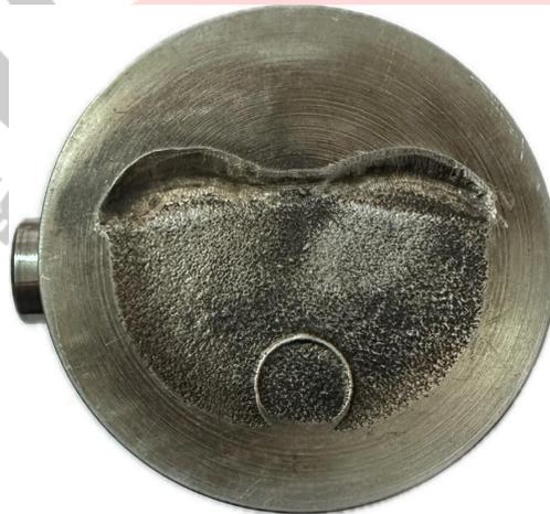
Se permite rehacer caladuras para que no peguen las válvulas. Se permite tornearse pollera en su interior, hasta 20mm de profundidad y un diámetro max. de 81mm.}
